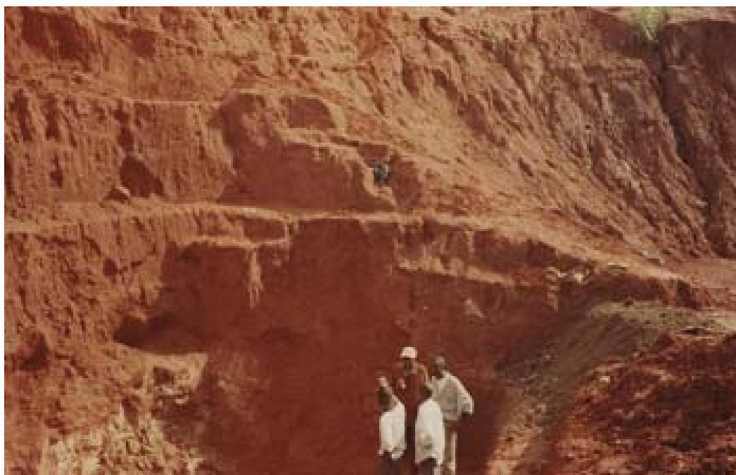
Un grand puits de 7 mètres de profondeur et 4 m 2 de circonférence dans la mine kimberlitique de Tshibue à Boya , à plus ou moins 45 km de Mbuji- Mayi
